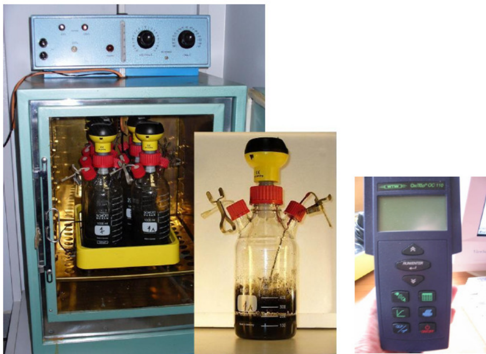
Joonis 7a Terviklik Oxitop® katseseade koos termostaadiga (foto A .Sergejev); b- OxiTop® andmehõiveseade (Foto: M. Koor)
