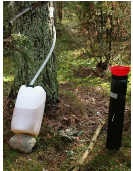
Joonis 20. Võrasademetekoguja (paremal) ja tüveveekoguja (vasakul).
