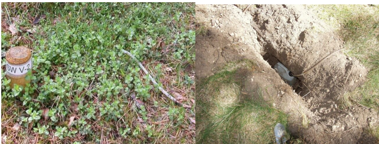
Joonis 25. Vasakul: mullavee kogumise koht. Paremäl fotol lahti kaevatud kogumisseade: maapinnaga paraleelselt asuva plaatja nõrgvee kogumipinna all asetseb voolikuga ühendatud kanister, sellest omakorda ulatub maapinnale teine voolik, mille kaudu vaakumi abil tõmmatakse vesi proovipudelisisse.
